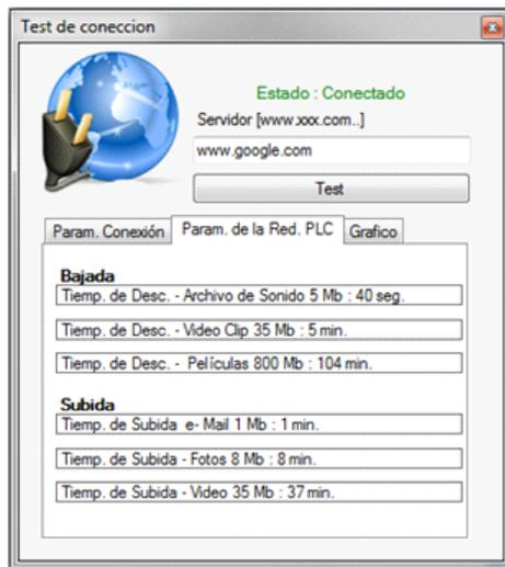
Figura 17. Tiempos de carga y descarga de archivos en la red PLC
