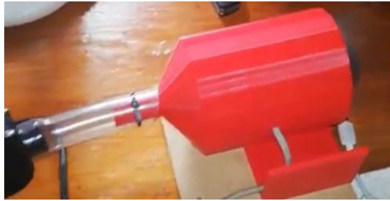
Figura 2: Implementación 3D de Turbocompresor de flujo axial
