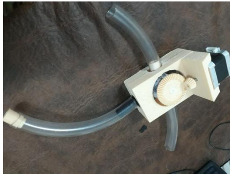
Figura 5: Válvula bidireccional basada en motor paso a paso
