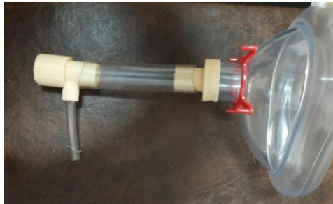
Figura 6: Sensor de presión y adaptador a mascarilla
