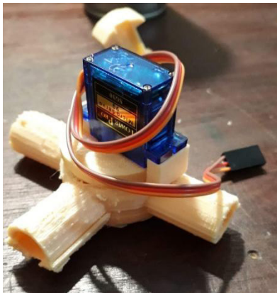
Figura 3: Válvula bidireccional servocontrolada
