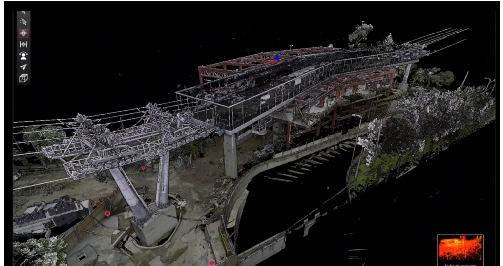
Figura 4. Leica RTC 360. Levantamiento de Nubes de puntos de la estación del cablebús Constituyentes. Fuente 3DArch México.
