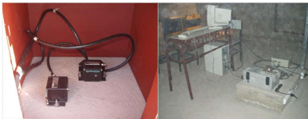
Figura 34. Instrumental sísmico instalado en el edificio aislado y en el de base fija
