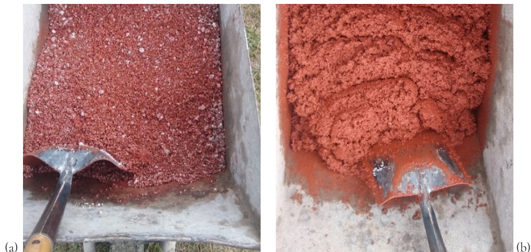
Figura 2. (a) Inclusión de los agregados para la realización de la baldosa, (b) Etapa final de la pasta
