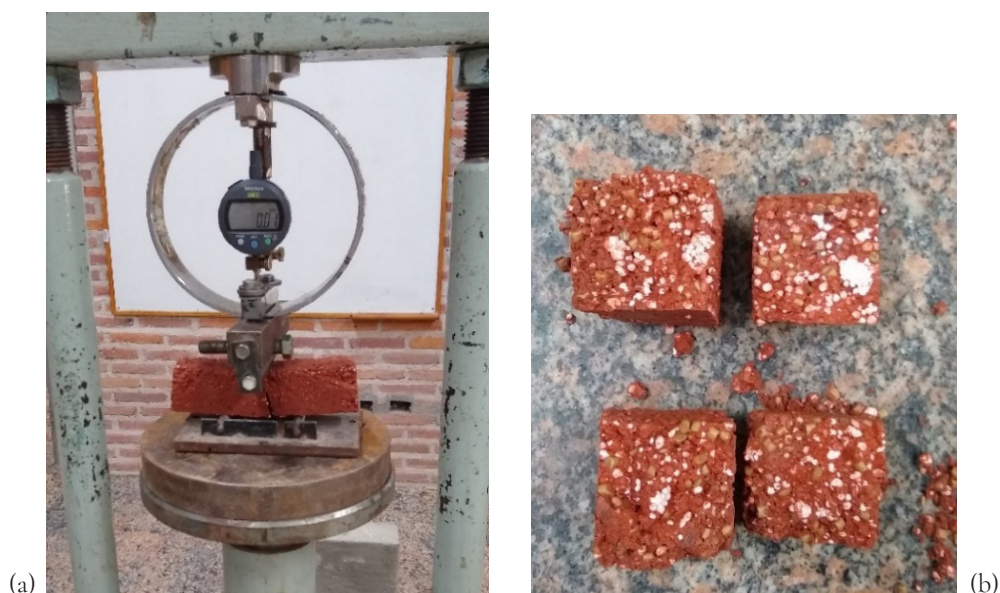
Figura 4. (a) Ensayo de la resistencia a la flexión. (b) Probetas B 3 (superior de la imagen) y B 2 (inferior de la imagen) luego del ensayo de resistencia a la flexión
