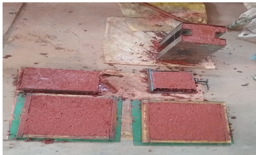
Figura 3. Llenado de los moldes para sus posteriores ensayos de conductividad térmica.
